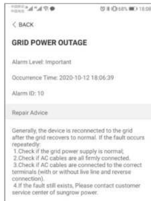
Figura 7-9 Informações detalhadas do alarme de falha
